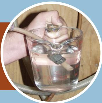
**6** Si la quantité déterminée d'eau disparaît de votre tasse à mesurer en quantité appropriée le médicamenteur fonctionne adéquatement. Si non, il faut le changer ou le réparer (i.e. si votre médicamenteur est réglé à 1 :100, quand il y aura 10 litres d'eau dans la chaudière placée sous le dispositif d'écoulement, il devrait y avoir 100 ml d'eau de moins dans la tasse à mesurer).
